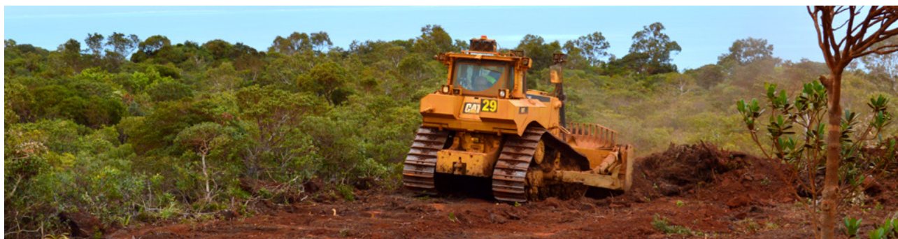
Défrichage et récupération de topsoil sur le massif de Tiébaghi.
